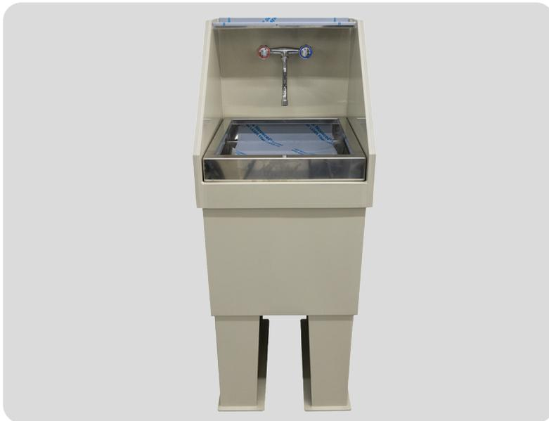
Lavabo de una estación con bomba sumergible y sistema de decantación + cartucho filtrante para recuperar limalla de metales preciosos y evitar su descarga al drenaje. Diseñado para joyeros y talleres de galvanoplastia.
