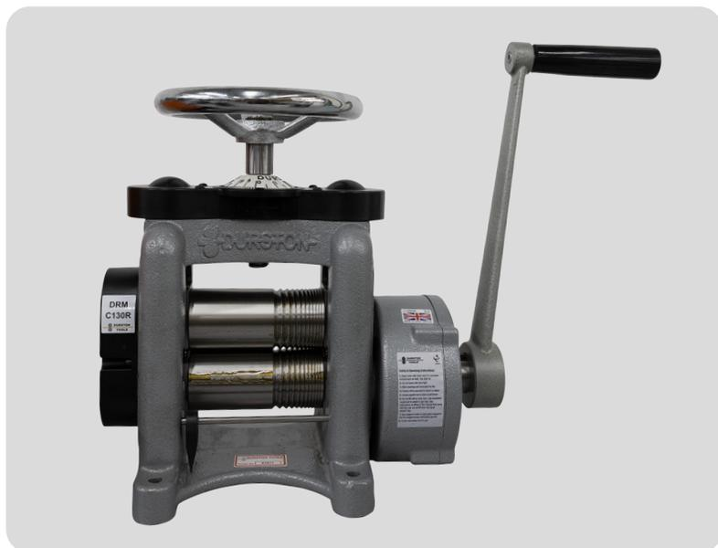
Laminador manual de combinación con rodillos de 130 mm y caja de engranes 5:1 que reduce el esfuerzo al laminar chapa y alambre de hasta 6 mm. Ofrece 75 mm de zona plana, 11 ranuras cuadradas y perfiladores de media caña. Su bastidor de hierro fundido y componentes sellados garantizan durabilidad, suavidad y bajo mantenimiento. Compacto y robusto, ideal para uso profesional diario.
